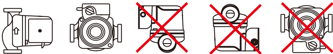
Fig2 posizione di installazione dell'elettropompa
