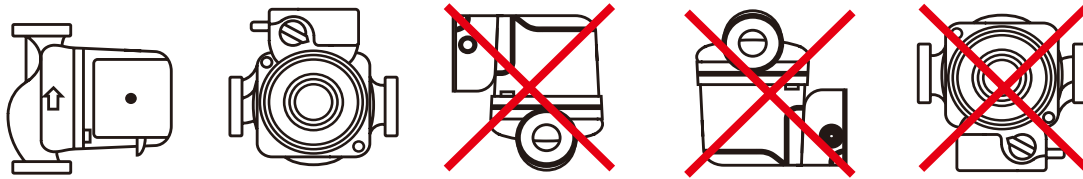
Abb. 2: Einbaulage der elektrischen Pumpe
