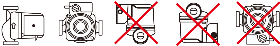
Fig2 installatiepositie van elektrische pomp
