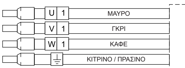
Αναγνώριση αγωγών καλωδίου ηλεκτρικών
