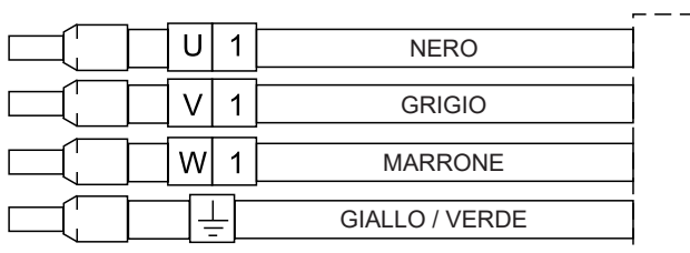
Identificazione conduttori cavo elettropompe
